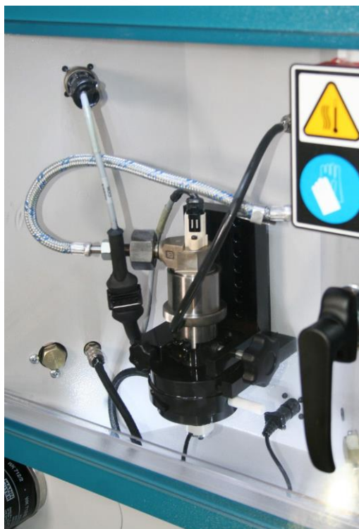
Встановлений інжектор з оснасткою
